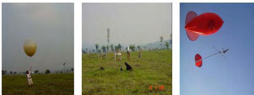
Figura 3.4 - Lançamento de Radiossonda, instrumento de SODAR e Balão Cativo na pastagem.
