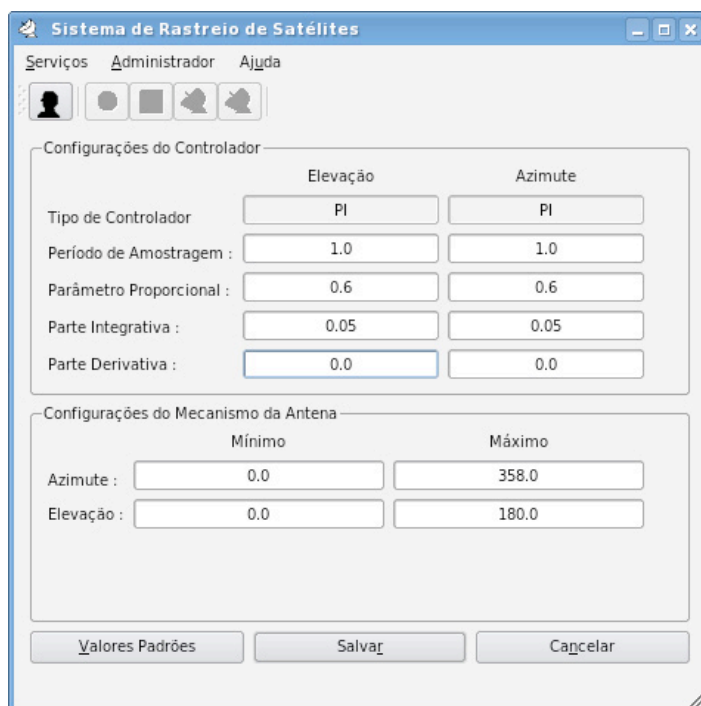
Figura 32: Tela de ajuste dos parâmetros do controlador PI e do controlador PID, acesso unicamente com privilégios administrativos
