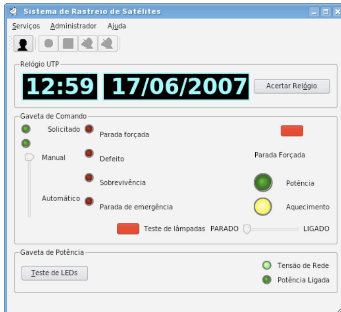
Figura 36: Tela para teste dos leds da gaveta de pilotagem e acerto do relógio do sistema
