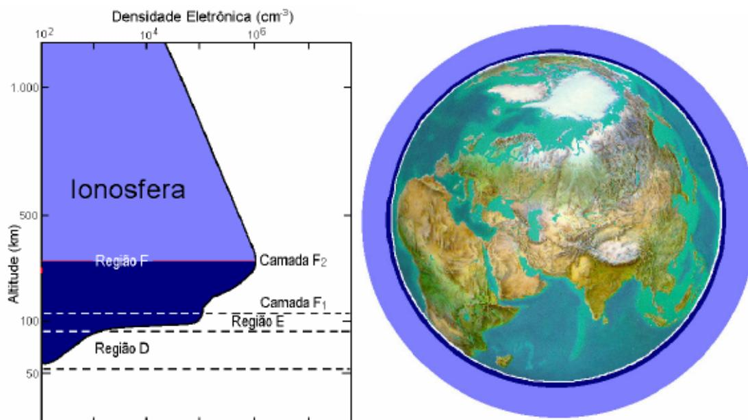
Figura 2 À esquerda, a localização das três camadas ionosféricas, com sua nomenclatura. E à direita, a dimensão aproximada da Ionosfera (em azul, similar à esquerda) em relação a Terra. Fonte Denardini (1999. p26)
