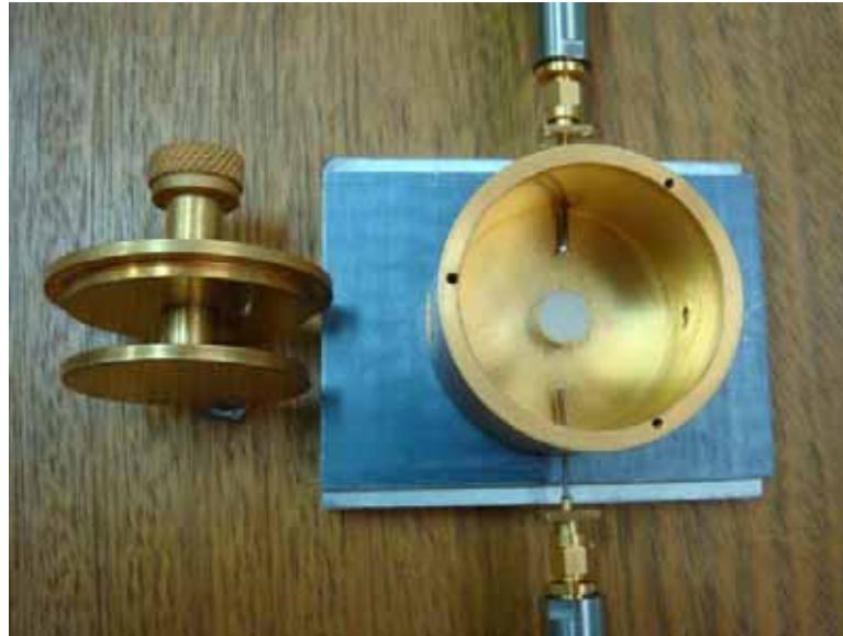
Figura 4. Caixa de teste com uma amostra para as medições em microondas das características dielétricas
