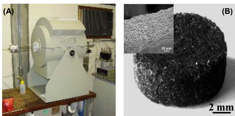
Figura 3.2 - (A) Fotografia da unidade de síntese de NFC e (B) imagem de uma pastilha de feltro de grafite com a superfície das fibras recoberta por NFC (detalhe).
