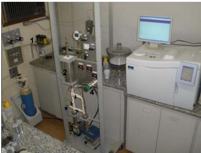
Figura 3.4 – Fotografia da Unidade de Síntese de FT: (1) controladores mássicos de vazão, (2) reator FT inserido em um forno tubular, (3) ampolas de amostragem e (4) válvula back pressure .
