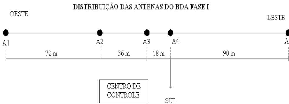
Figura 3.1 - Localização relativa das antenas e as correspondentes linhas de base no PBDA. Diagrama tomado de Sawant et al. (2005)
