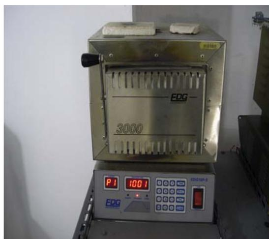
Figura 3.11 – Forno tipo mufla
