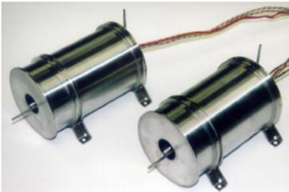
Figura 1.2 - Protótipo do resistojoato construído pela Surrey.
