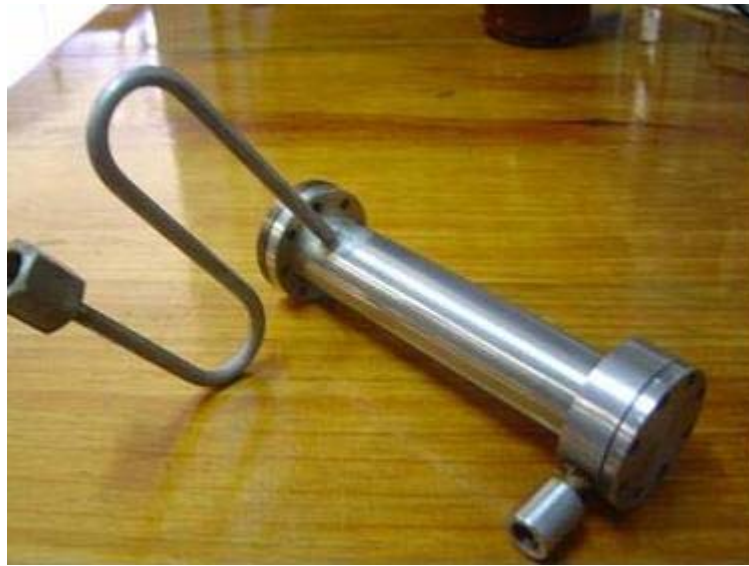
b) Câmara termo-catalítica adaptada.
