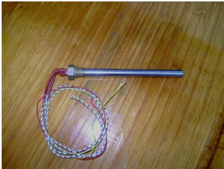
b) Resistência elétrica.
