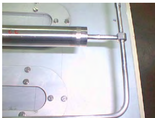
(b) Detalhe da solda das conexões
