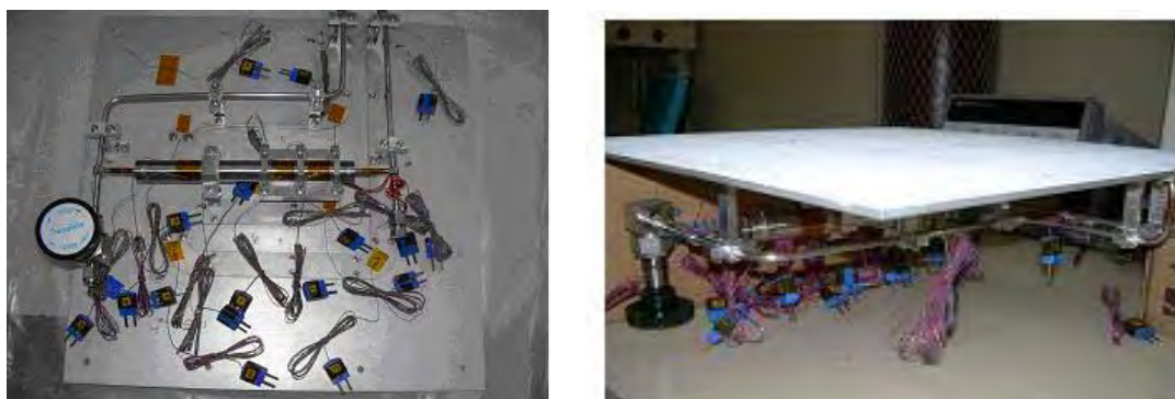
Figura 6.21. Modelo da qualificação do LHP: (a) instrumentação sem o isolamento; (b) radiador pintado com tinta branca.
