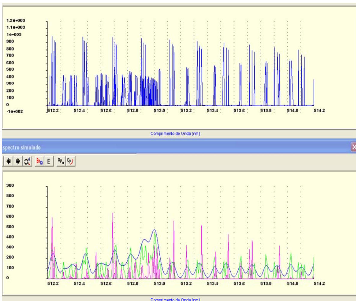
Figura 3.19 - Sobreposição dos espectros com diferentes resoluções (azul - 0,05 nm, verde - 0,01 nm e magenta - 0,001 nm) 1000 passos e intensidades não normalizadas na região de zoom.
