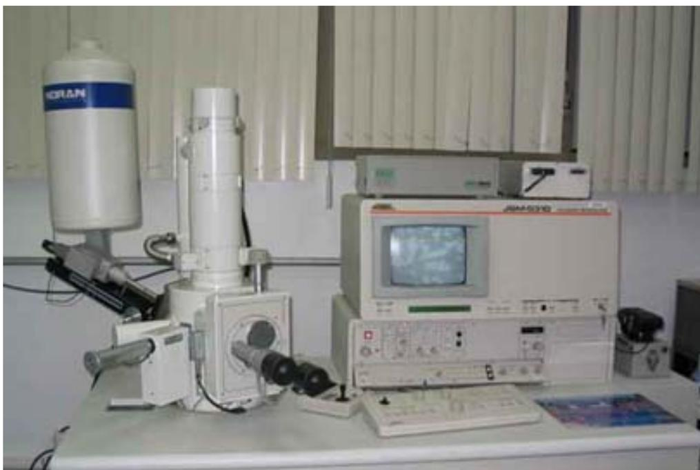
Figura 4.6 – Microscópio eletrônico de varredura JEOL com capacidade de análise de energia dispersiva por raios X
