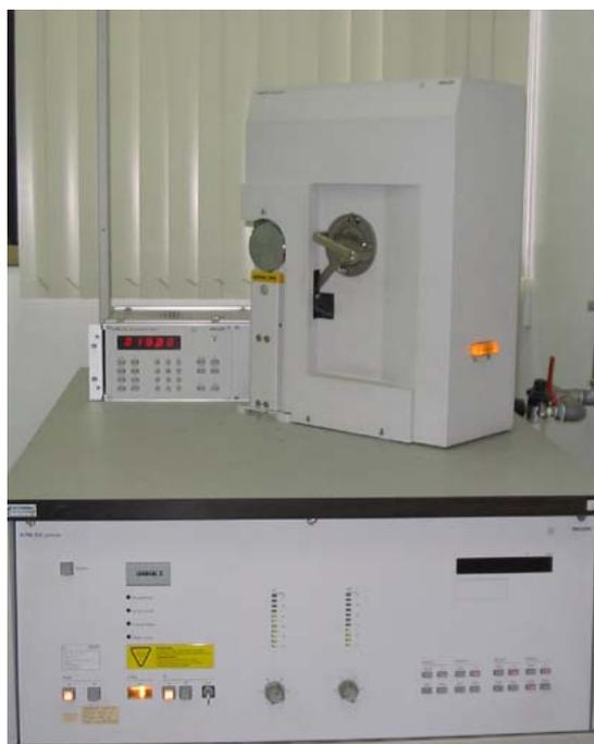
Figura 4.16 – Difratorômetro convencional PHILIPS PW 1830 / 40
