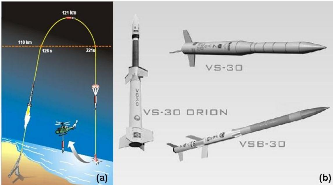
Figura 1.4 – (a) Esquema de uma missão típica do VS-30; (b) Foguetes de sondagem brasileiros para microgravidade
