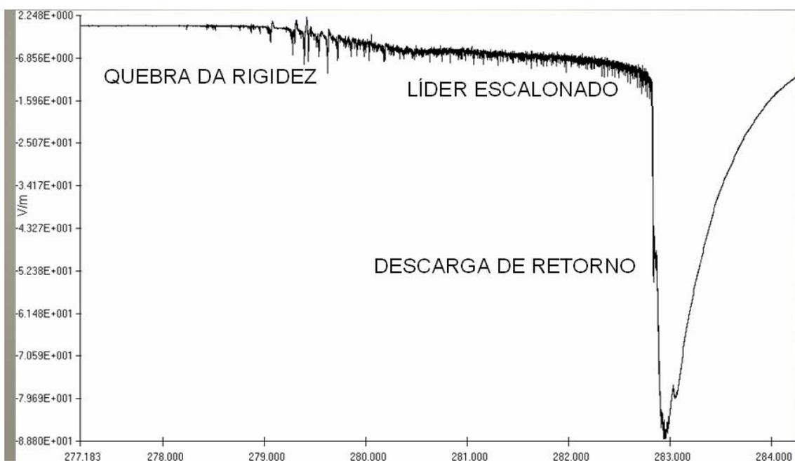
Figura 2.11 – Variação do campo elétrico devido à quebra de rigidez preliminar e ao líder escalonado, que antecederam a descarga de retorno de um relâmpago nuvem-solo negativo. A convenção adotada é de que o campo elétrico negativo é para baixo.
