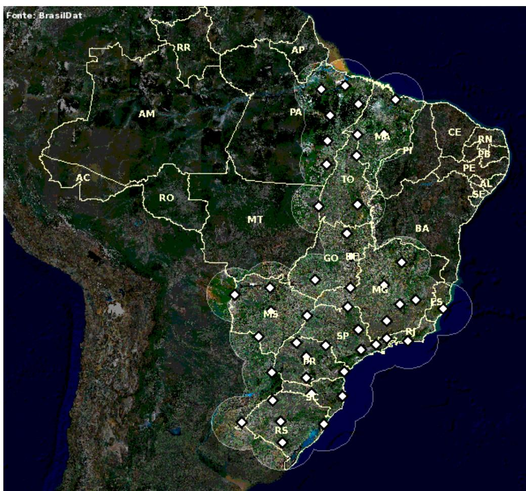
Figura 3.3 – Localização dos sensores e abrangência da rede de detecção de descargas atmosféricas BrasilDat.
