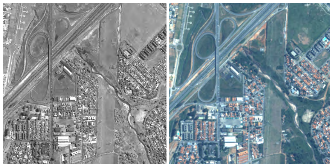
Figura 5.14 - Imagem pancromática de São José dos Campos e composição colorida R3G2B1 das imagens multiespectrais reamostradas.
