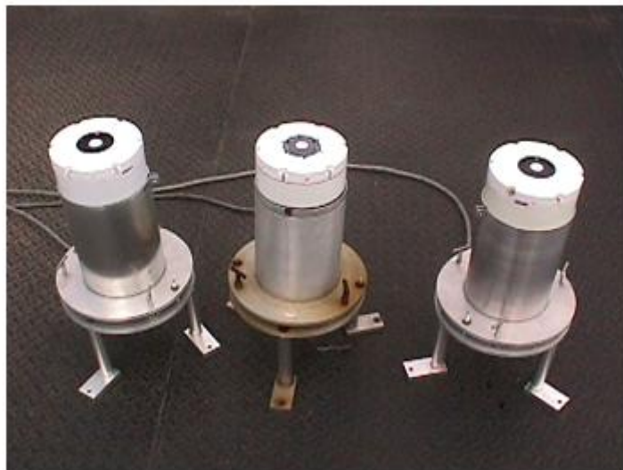
Fig.2 – Radiômetros em processo de intercomparação com padrão.
