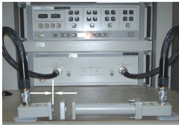
Fig. 3. Configuração para medidas dos parâmetros S [2,5].
