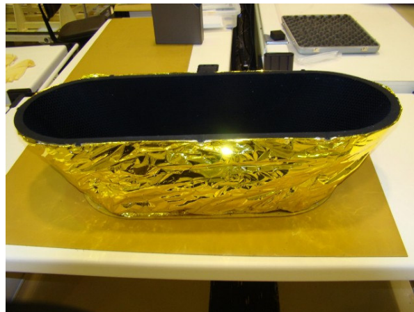
Figura 17 – Modelo estrutural de uma câmara imagiadora de satélite
