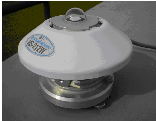
Fig. 4.3 – Radiômetro UV-B MS-212 W instalado na plataforma do OES.
