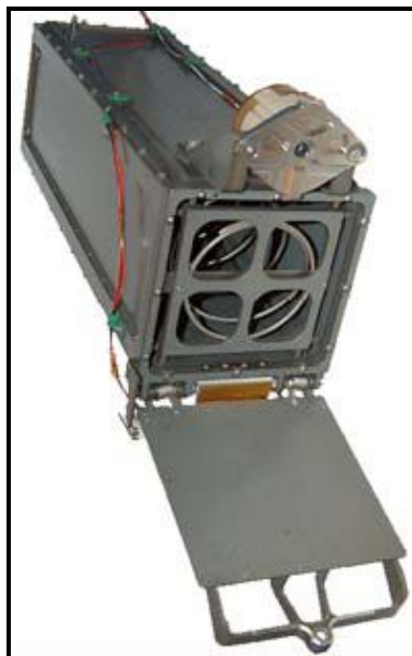
Figura 11: Abertura do P-POD para ejeção dos Cubesats
