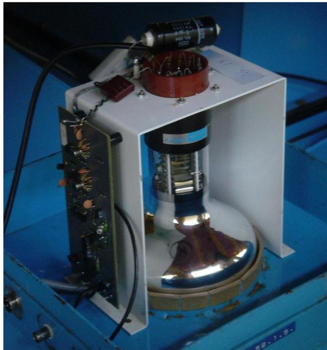
**Figura 3.7 – Foto da fotomultiplicadora utilizada no detector de raios cósmicos – muons.**
