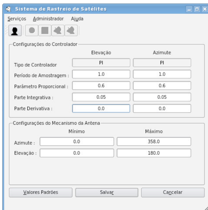
Figura 21: Tela de ajuste dos parâmetros do controlador PI e do controlador PID, acesso unicamente com privilégios administrativos
