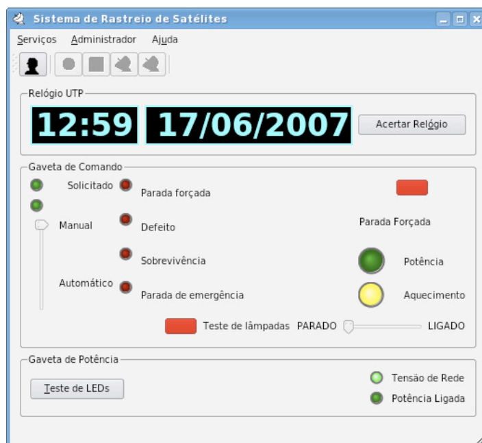
Figura 25: Tela para teste dos leds da gaveta de pilotagem e acerto do relógio do sistema
