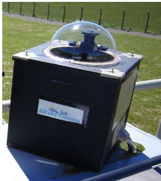
Figura . 9 - 1 Imagem da Câmera Imageadora Fish-Eye , instalada no OES.
