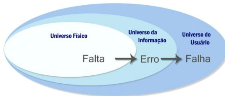
Figura 1.1 – Relacionamento entre os conceitos: falta, erro e falha.
