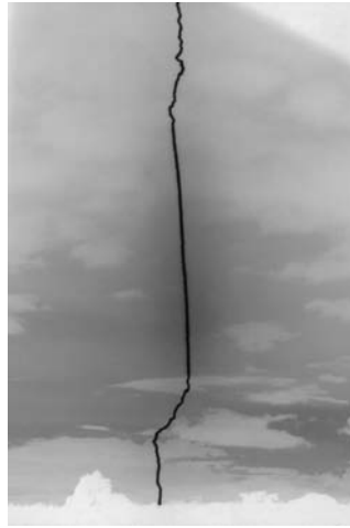
Figura 4.1 - Exemplo de relâmpago iniciado artificialmente por foguete utilizando-se o método “de altitude”.
