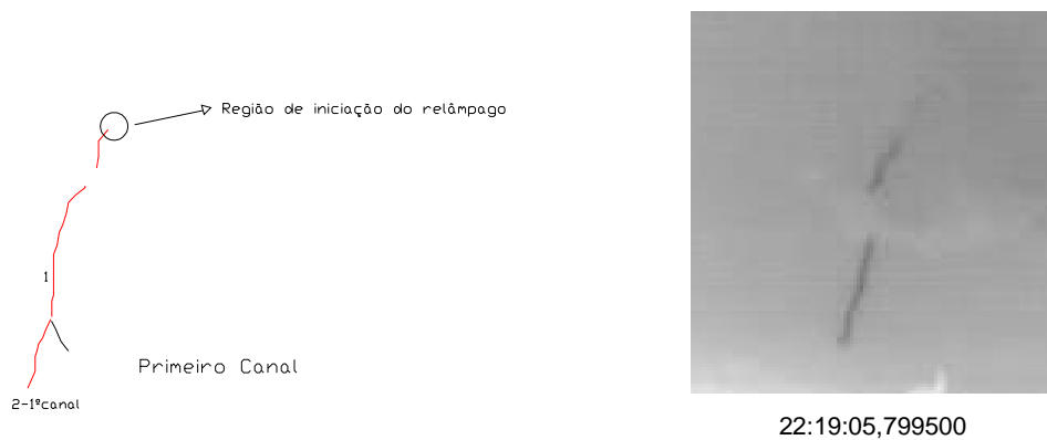
Figura 7.8 - Formação do primeiro canal do relâmpago. A imagem à direita mostra o canal cujo contato com o solo já se encontra estabelecido. Na figura à esquerda é possível ver a seqüência cronológica dos eventos desde a iniciação do relâmpago.
