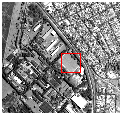
Figura 7. Resultado do processo de reconhecimento automático de campo de futebol em uma imagem Ikonos contendo a instalação do INPE de São José dos Campos
