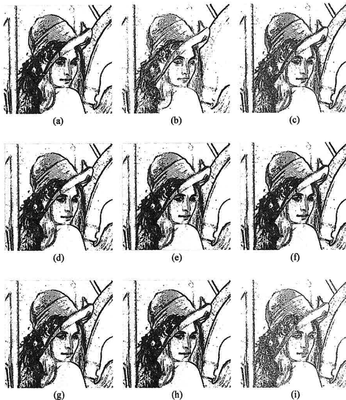
FIGURA 5.16 – Resultado das Redes Neurais treinadas com 26 padrões binários e com limiar da variância igual a 50 para imagem Lena RGB: (a) BAM, (b) ART1, (c) ART2, (d) RPMC, (e) RBF, (f) LVQ1, (g) LVQ2, (h) FAM e (i) Maxnet.
