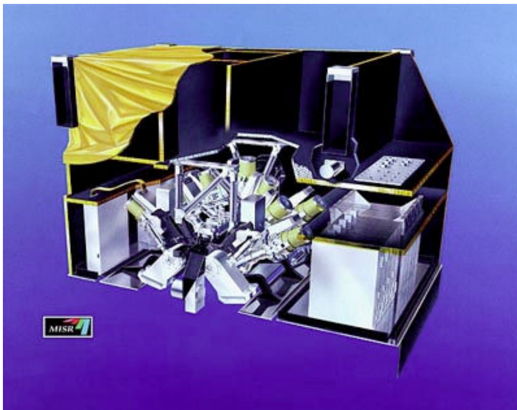
FIGURA 2.7 – Concepção artística do MISR em corte. Os cilindros amarelos são as extremidades das câmeras.
