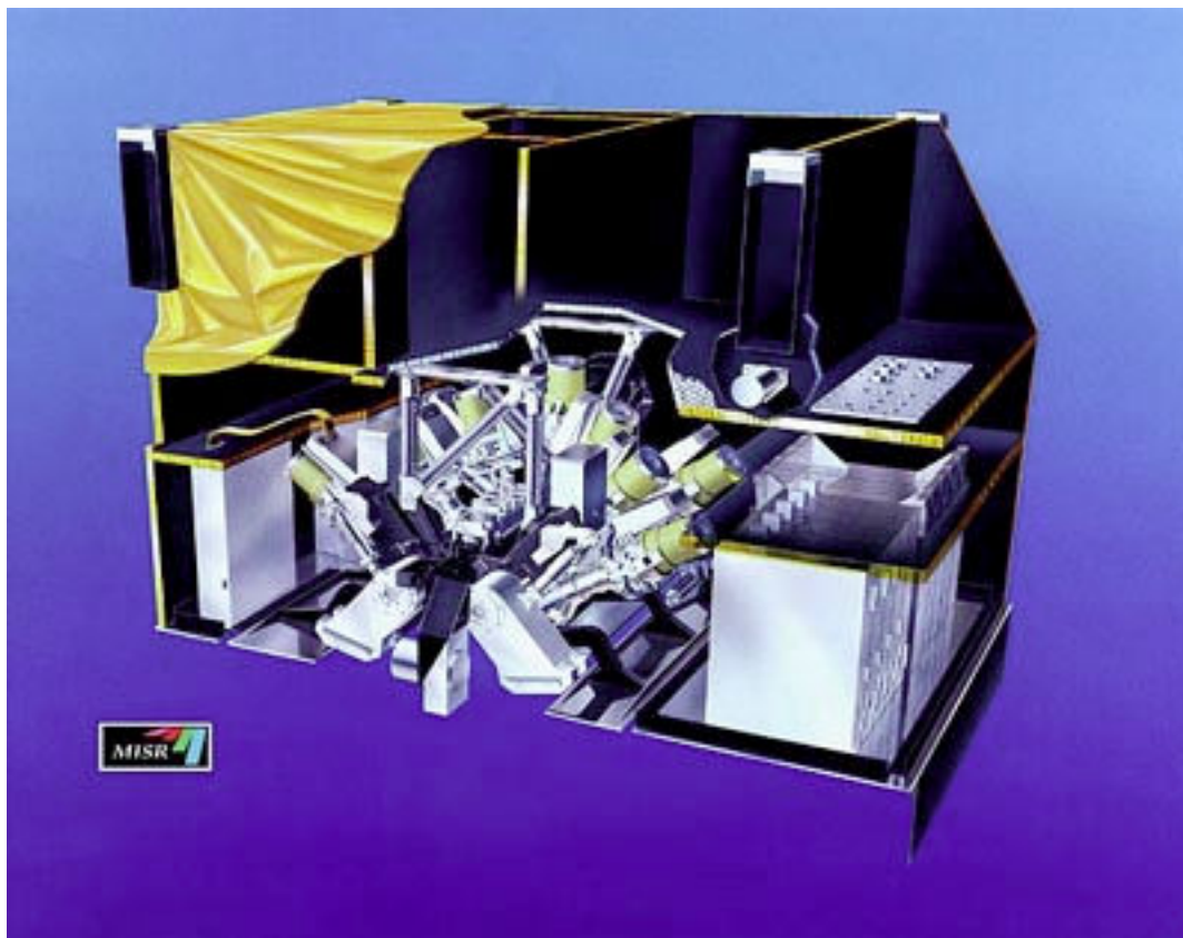
FIGURA A.3 – Concepção artística do MISR em corte. Os cilindros amarelos são as extremidades das câmeras.
