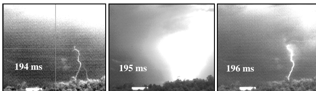
FIGURA 3.7 – Quadros consecutivos envolvendo a DR bifurcada do raio 237, ocorrido em 29/mar/2004, às 17h12min43s (UT). Os dados temporais indicados são provenientes do GPS da camera rápida. Da esquerda para a direita: líder escalonado com os dois ramos principais prestes a conectar o solo; conexão da DR; CC no ramo esquerdo – o ramo direito ou se extinguiu ou possui baixos níveis de luminosidade.
