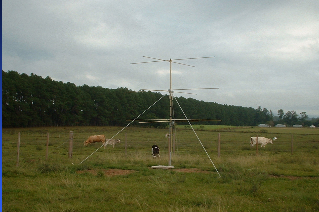
Fig. 1 – Antena Transmissora, do tipo Yagi de 3 elementos, do Sistema SKiYMET do CRSPE/INPE – MCT, instalado em Santa Maria, RS.
