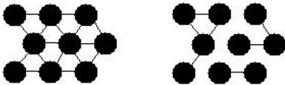
Figura 1. O algoritmo Costa-Neto elimina conexões inconsistentes entre os neurônios para encontrar a partição ideal da grade.
