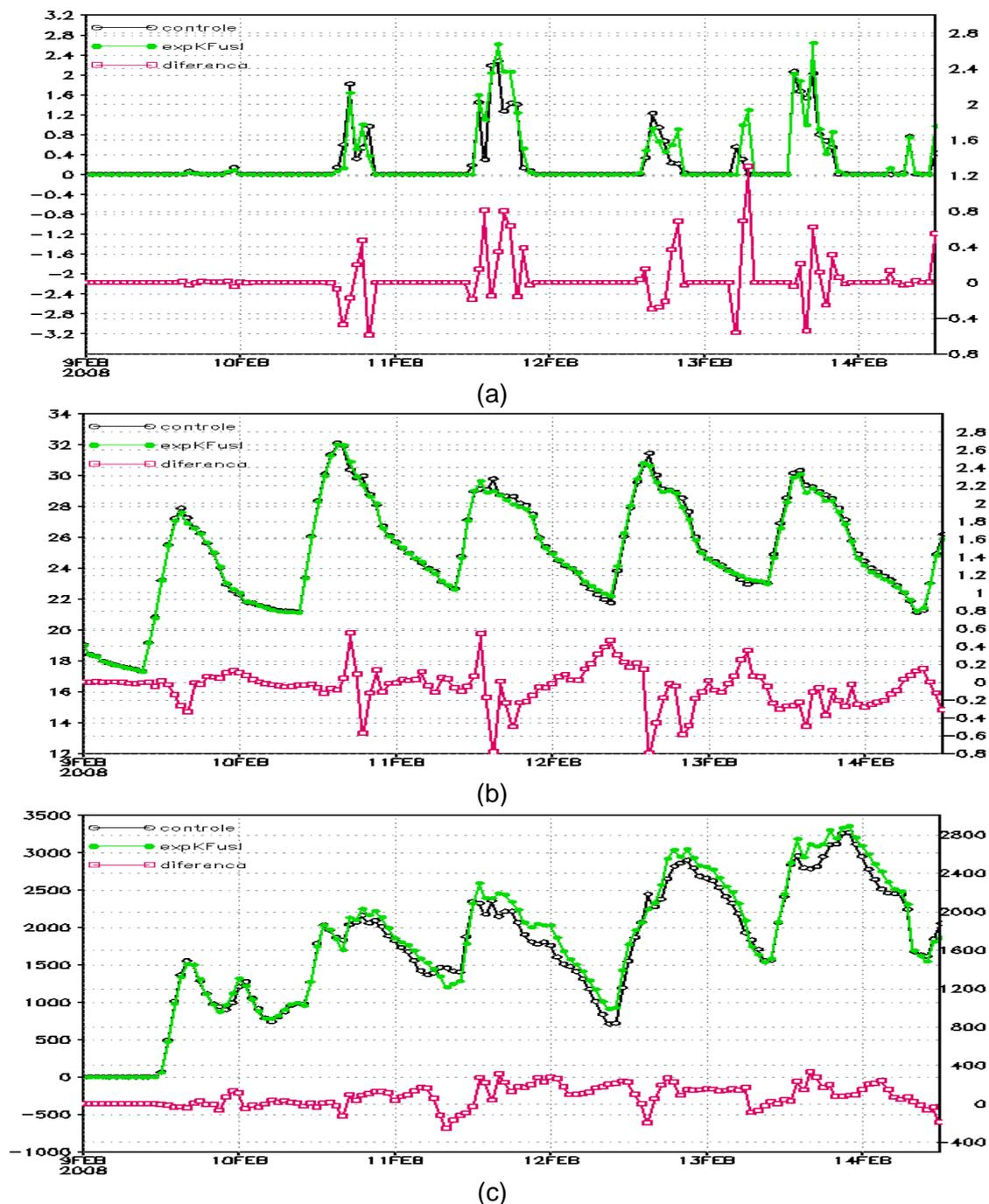
Figura 4.16 - Evolução temporal para 132 horas de simulação iniciada no dia 09 às 00Z no litoral (figura 4.10) da (a) precipitação convectiva (mm/h), (b) temperatura a 2m (°C) e (c) CAPE (J/kg). A linha preta representa a simulação controle, a verde o experimento (com valores representados no eixo esquerdo) e a rosa a diferença entre o experimento e a simulação controle (com valores representados no eixo direito).
