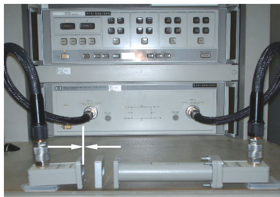
Fig. 3. Instrumentação para medida dos parâmetros S [3,8].
