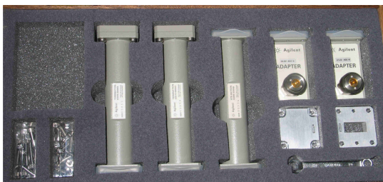
Fig. 2. Conjunto de calibração em guia de ondas para a banda X [3].
