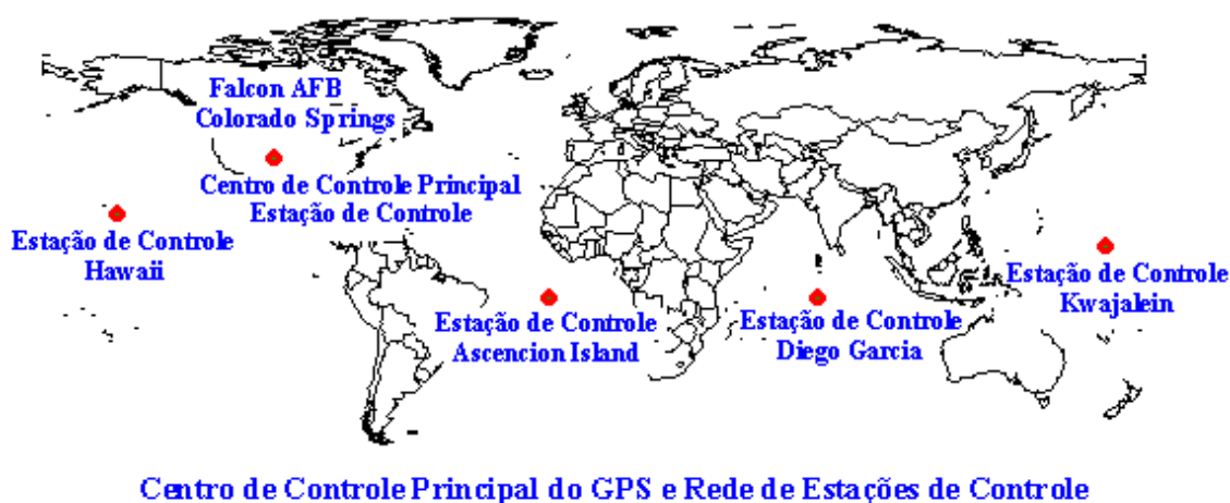
FIGURA 4.3 - Centro de controle principal e rede de estações de controle do sistema GPS.
