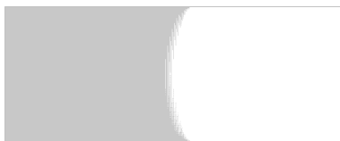
Figura 7. Solidificação de cerca de 50 % da ampola, no instante 2048.4 s.
