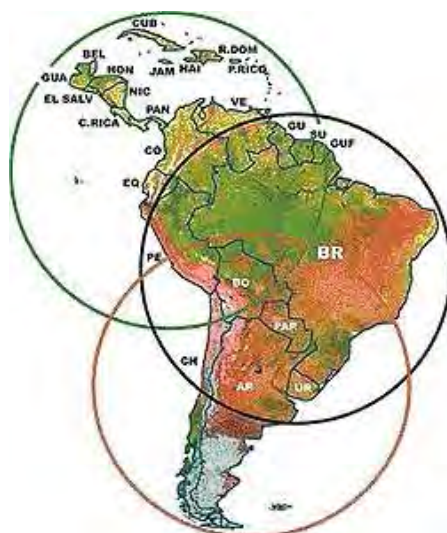
Figura 21- Localização das estações de rastreamento e recepção de dados de satélites de sensoriamento remoto na América do Sul, Cuiabá (círculo preto), Faldas del Carmen (círculo vermelho) e Cotopaxi (círculo verde).
