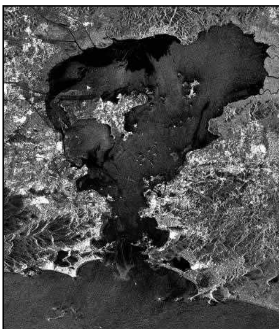
Figura 11- Imagem do sensor ativo do satélite RADARSAT da Baía de Guanabara, onde aparece um derramamento de óleo na porção noroeste superior da baía. Fonte: http://www.rsi.ca/products/gallery/rs1.asp Setembro de 2004
