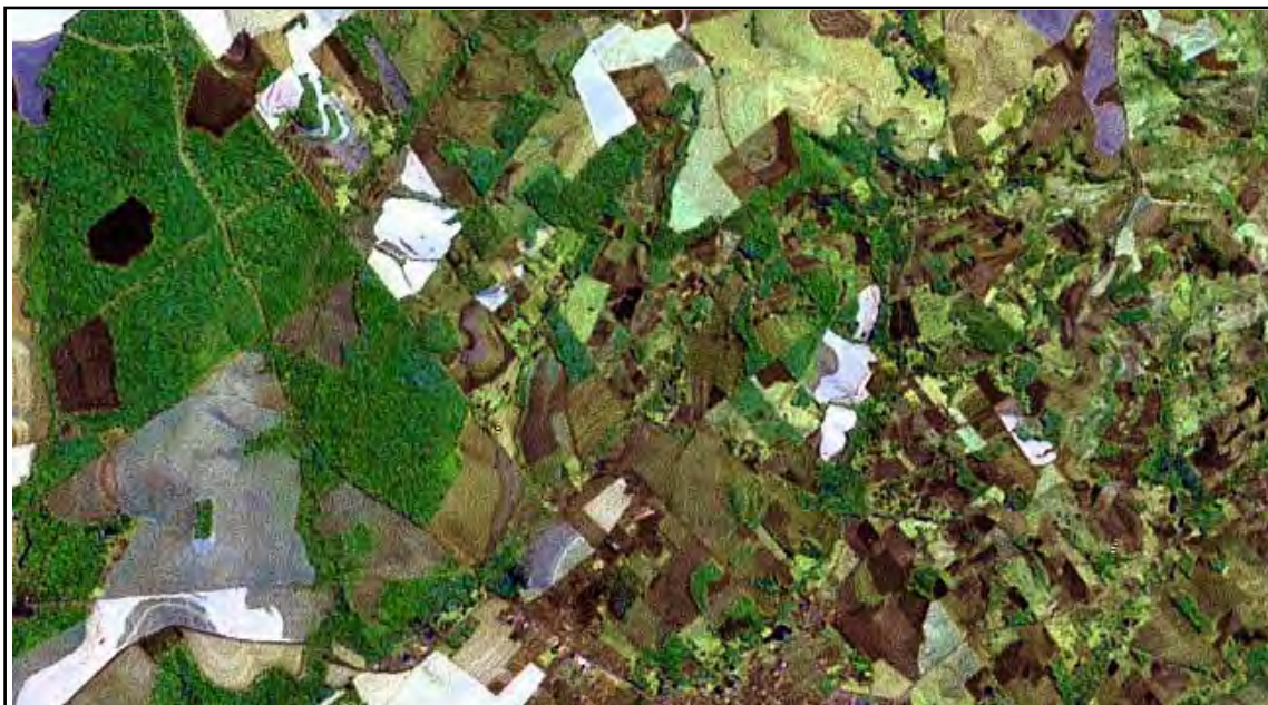
Figura 29- Extrato de imagem LANDSAT TM de uma região do Paraná onde se pode observar que a textura da imagem do lado esquerdo da uma sensação de mais lisa se comparada com a porção direita que aparenta ser mais rugosa. Esta mudança na textura indica mudança no tipo de relevo que inclusive condiciona o tipo de agricultura em cada uma das áreas.
