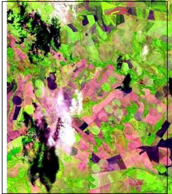
Figura 30-Neste recorte de imagem TM/LANDSAT 5 de uma região do Estado do Mato Grosso do Sul, adquirida em 15/11/1990, se pode observar na porção esquerda a ocorrência de nuvens (branco) e imediatamente ao lado a sombra da nuvem (preto). Fonte: http://www.dgi.inpe.br
