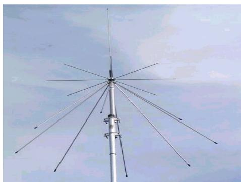
FIG. 2.2.1 – ANTENA OMNIDIRECIONAL D-130
