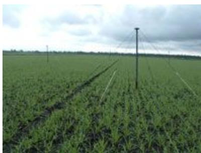
FIG. 2.2 – ANTENA DE BANDA BAIXA – (30 – 80) MHz.
