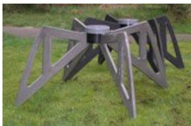
FIG. 2.3 – ANTENA DE BANDA ALTA – (120 - 240) MHZ.
