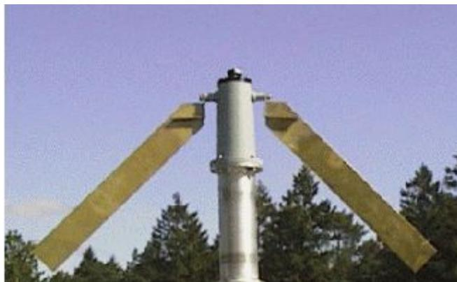
FIG. 4.2 – PROTÓTIPO DE ANTENA DO LOFAR.
