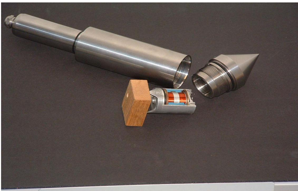
FIG. 1.3.1.1.4 – MICROBAROMETRO KNMI
