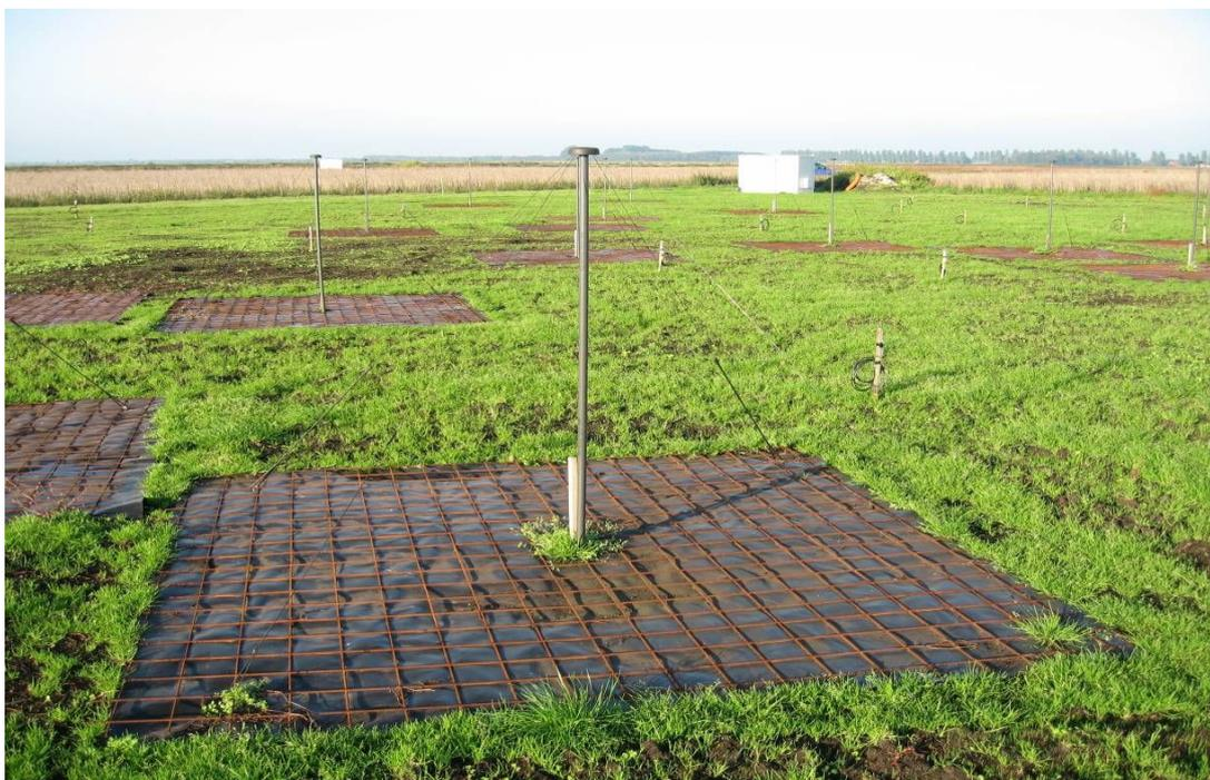
FIG. 1.3.1.1.1 – ANTENAS DE BANDA BAIXA OPERANDO EM UMA ESTAÇÃO LOFAR
