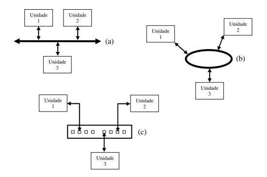
Figura 2.14 – Topologias de Rede: (a) "barramento, (b) "anel", (c) "estrela".
