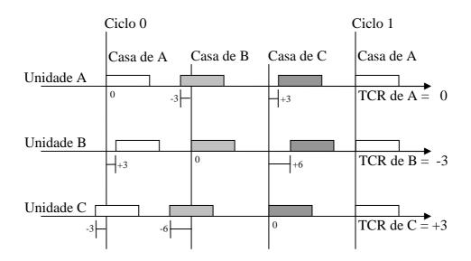
Figura 6.6 – Exemplo simplificado de aplicação do algoritmo Welch-Lynch.
