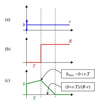
Figura 2.10 – Evolução do tráfego retido usando "rate functions".
