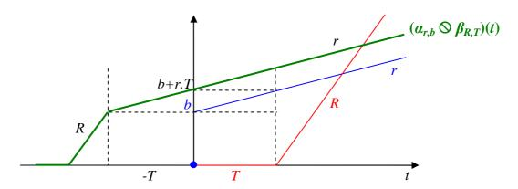
Figura 2.8 – Deconvolução de funções "Affine" αr,b e "Rate-Latency" βR,T.
