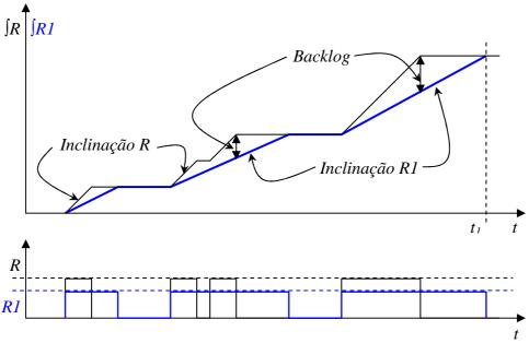
Figura 2.1 – Função cumulativa em "Network Calculus". Fonte: Adaptada de Cruz (1991).
