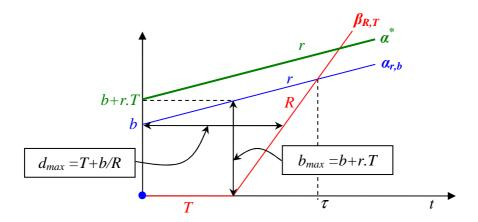
Figura 2.9 – Os três limites em funções "Affine"  $\alpha_{r,t}$  e "Rate-Latency"  $\beta_{R,T}$ . Fonte: Adaptada de Le Boudec, Thiran (2994).
