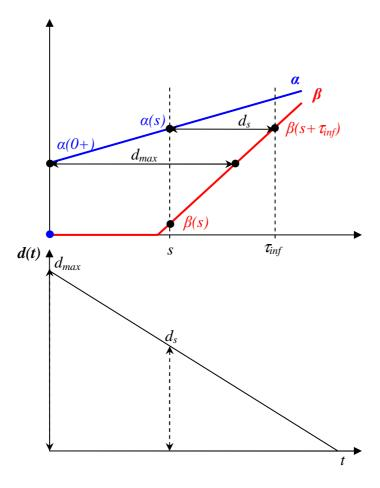
Figura 2.5 – Atraso máximo em um fluxo de entrada.
