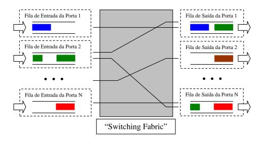
Figura 2.16 – Elementos lógicos de um "switch" Ethernet.
