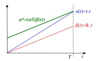
Figura 2.13 – Limite do fluxo de saída para um caso R < r.
