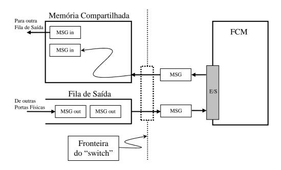
Figura 6.2 – Modelo da porta física do "switch" ligada à FCM.
