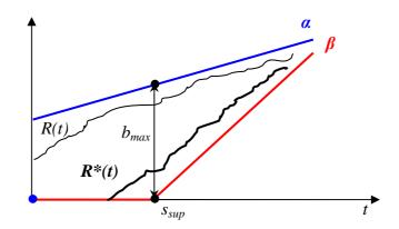
Figura 2.4 – Limite superior do tráfego retido em um sistema.
