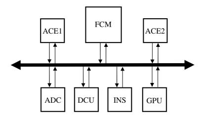
Figura 6.3 – Corretor de trajetória usando topologia em "barramento".
