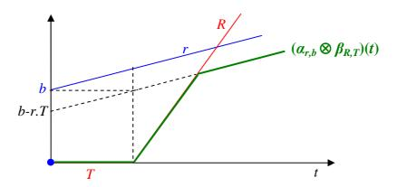
Figura 2.7 – Convolução de funções "Affine"  $\alpha_{r,b}$  e "Rate-Latency"  $\beta_{R,T}$ .
