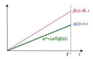
Figura 2.12 – Limite do fluxo de saída para um caso R > r.
