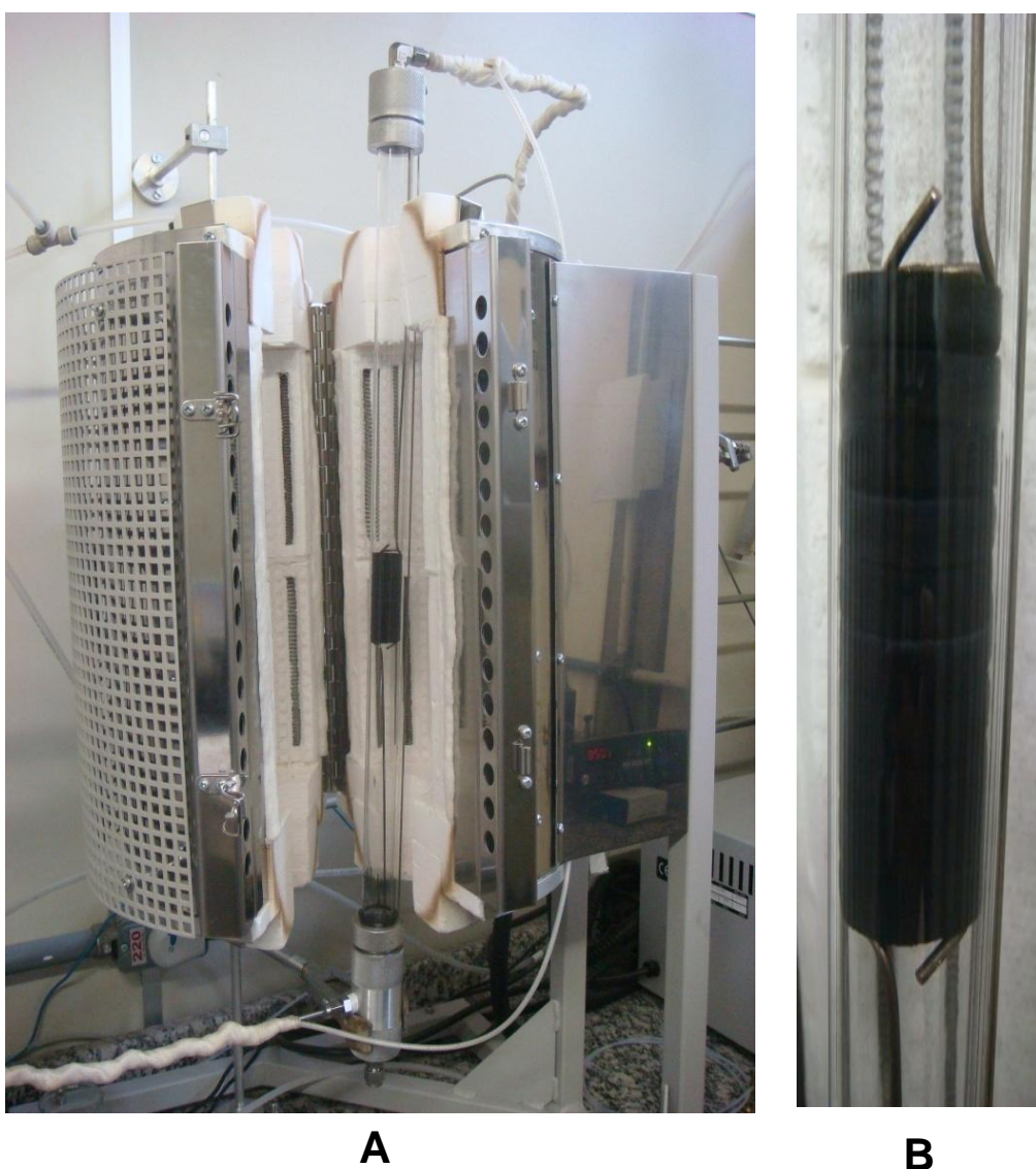
Figura 4.4: Fotografia ampliada: A: Reator, B: Catalisador alocado no interior do reator.
