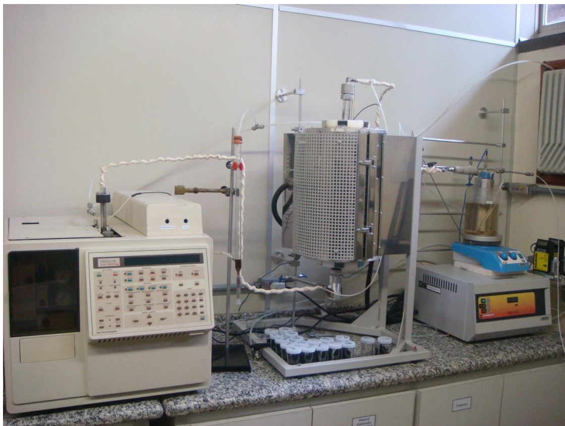
Figura 4.3: Fotografia da unidade de testes catalíticos para a reação de oxidação direta do H 2 S em enxofre elementar.
