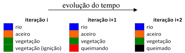
Figura 4: Transições de estado das células em função do atributo ambiental. Uma célula não-combustível, que pode ser aceiro ou rio, sempre permanece em seu estado. Uma célula combustível permanece em seu estado caso ela não seja levada à ignição. Uma vez ocorrendo a ignição no passo de tempo i , o estado da célula combustível no passo de tempo i + 1 será queimando (cor vermelha) e depois em i + 2 será queimado (cor preta).
