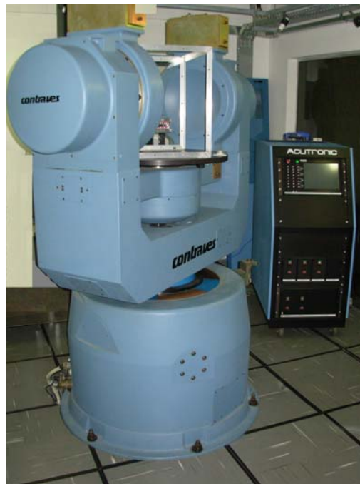
Figura 2.2 - Simulador dinâmico servo assistido e controlador ACL/3000
