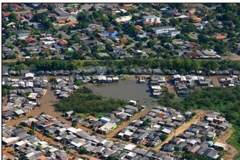
Figura 6.68 - Dique de proteção contra cheias resguardando a cidade de São Leopoldo (à leste) contra a inundação do rio dos Sinos, provocada pela passagem do ciclone extratropical.
