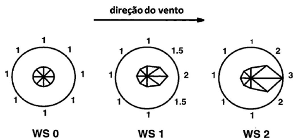
Figura 9: Representação dos fatores de tendências direcionais usado para simular os efeitos da direção do vento. Sem vento ou vento fraco (WS 0: 0-5 km/h), vento moderado (WS 1: 5 - 20 km/h) e vento forte (WS 2: maior que 20 km/h). A flecha indica a direção do vento. Para WS 0 todos os fatores de tendências são iguais a 1 (sem tendência). O vento pode ser simulado vindo de qualquer uma das oito direções através da rotação da matriz de fatores de tendências até que o maior fator está posicionado a favor do vento. Figura adaptada de [10].
