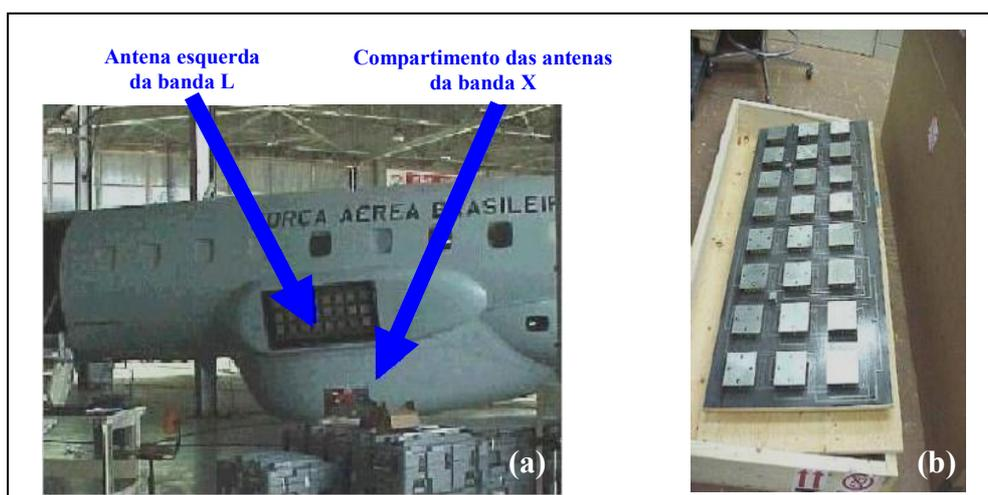
Figura 4.4 – a) Localização das antenas SAR no R99-B. b) Antena da Banda L.
