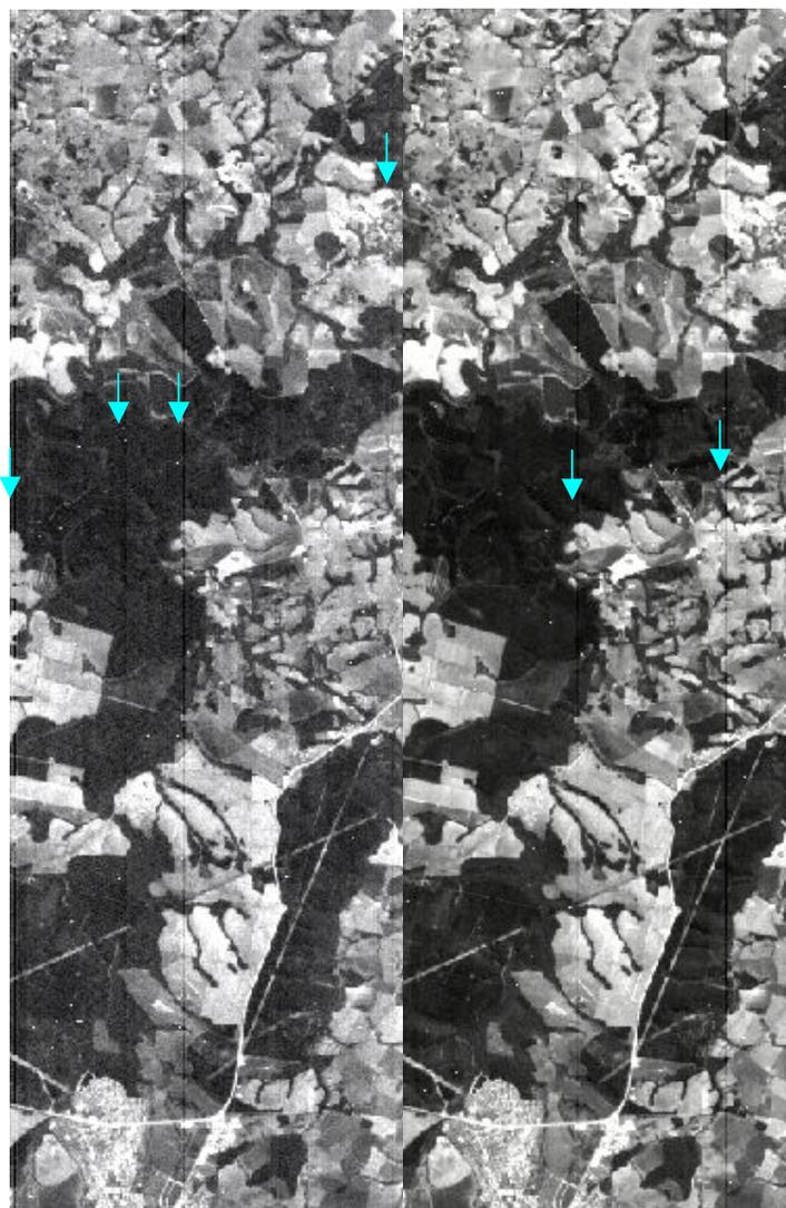
Figura 3.5 - Presença de *striping* nas bandas referentes aos comprimentos de onda de 467 e 518 nm, respectivamente.
