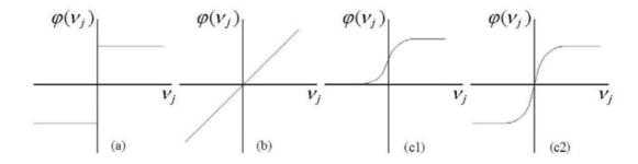
Figura 2.6 – Sinais de saída de diferentes funções de ativação: a) função degrau; b) função linear; c) função sigmoidal logística; d) função sigmoidal tangente hiperbólica.
