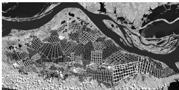
Fig. 3 – Conjunto de rotas planejadas para levantamento batimétrico. (Fonte: BARBOSA, 2004)
