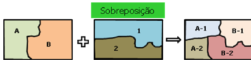
Figura 10 – Operador de sobreposição: as classes resultantes são combinação dos planos de informação de origem.
