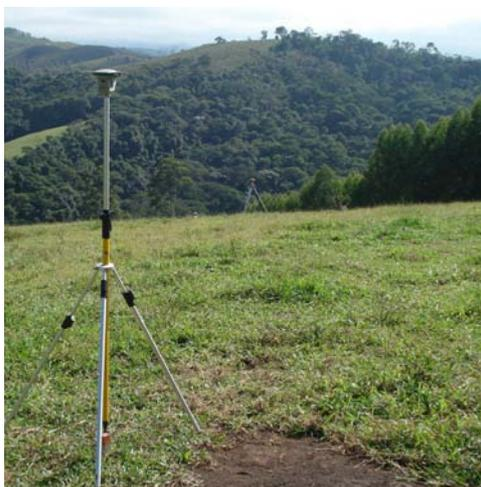
Figura 3.6 – Rastreamento simultâneo de L1L2 (Base) e L1 (Sub-base)
