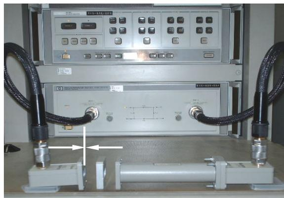
Fig. 3. Instrumentação para medida dos parâmetros S [3,8].
