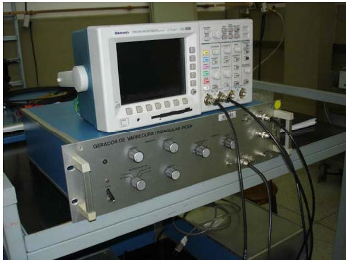
Figura 3.4 Osciloscópio conectado ao gerador de varredura
