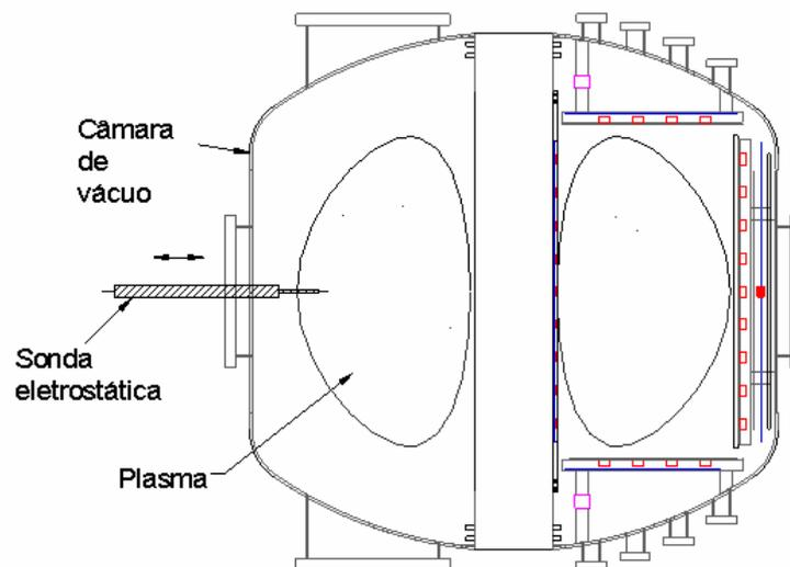
Figura 2.1 - Esquema de uma sonda eletrostática inserida em um plasma neutro
